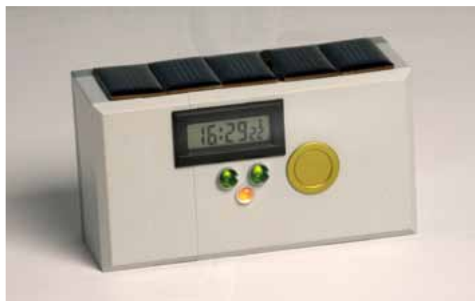
„Call-Button“ für Materialanforderungen mit Solar-Betrieb
